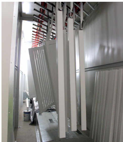
Painted products in drying chamber / Lackierte Produkte in der Trockenkammer / Les produits peints transitent par une chambre de séchage. / Productos pintados en la cámara de secado / Prodotti verniciati in camera di essiccazione / Geschilderde producten in droogkamer
