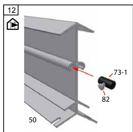
**Nedløb - Downpipe - Fallrohr - Stuprör - Tuyan de descente - Goot - Canalón - Scarico - Syöksytorvet**
